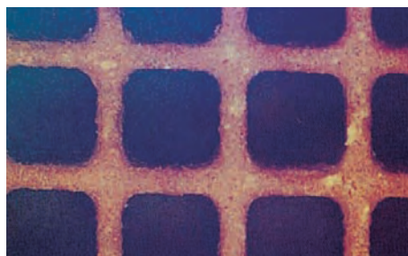
セラミックハニカム触媒の端面拡大
